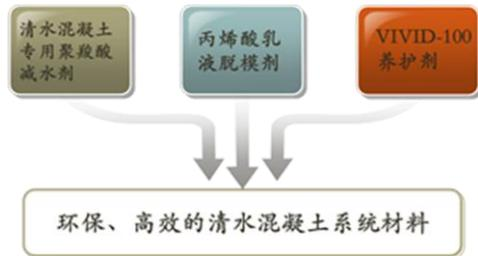
利用高性能的清水混凝土专用聚羧酸减水剂提高新拌混凝土的施工性，采用水性丙烯酸乳液作为脱模剂减少混凝土与模板的界面粘结力，进一步改善混凝土外观效果，最终在拆模后的混凝土表面喷涂养护剂，保证混凝土充分水化，防止表面开裂。
